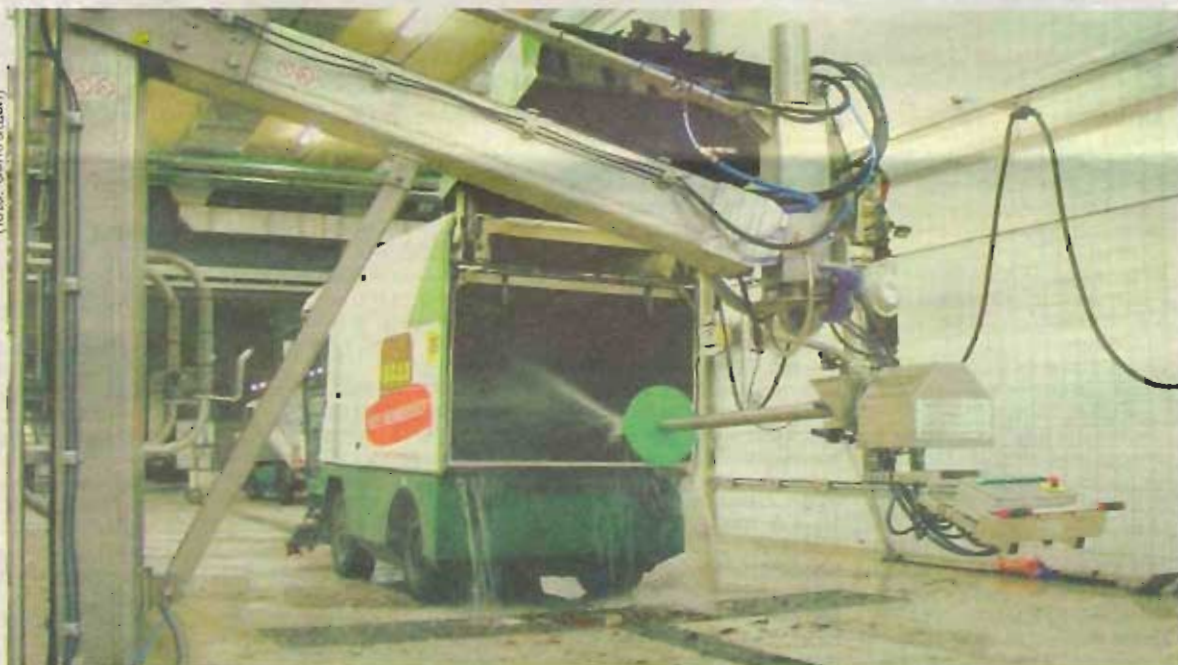
De 'CyberjEt' maakt robotreiniging van inwendige tanks efficiënter.
