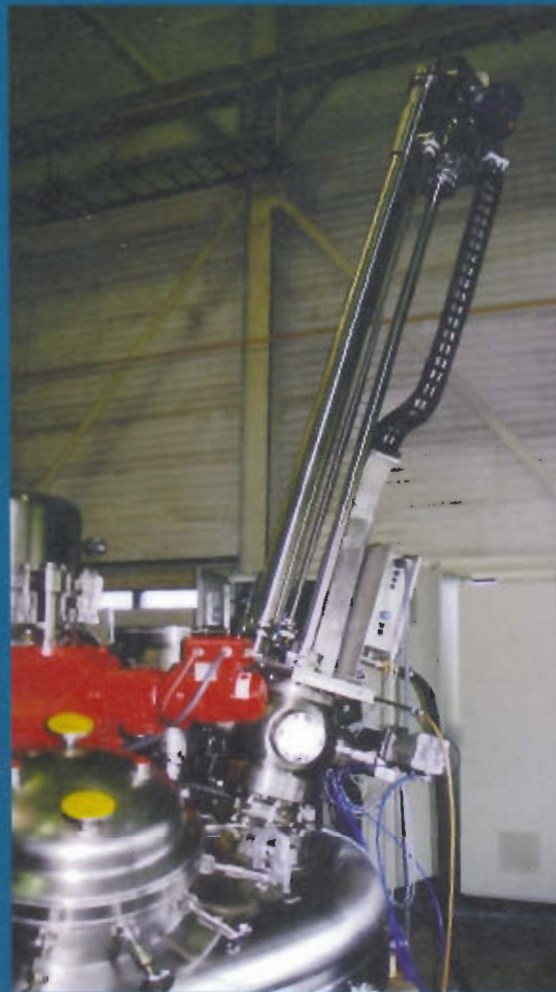
Abf. 2 De Cyberjet kan in de tank worden opgetrokken
